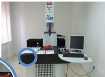
Aparatura za merjenje obrabe površine vsadka
